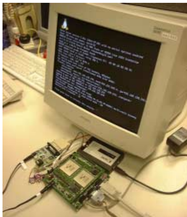
写真2. Linux/M32R ブート時のコンソール表示の様子。 SDI 機能を利用して M32R 用 Linux カーネルをダウンロード・実行している。左のボードが簡易エミュレータ。
